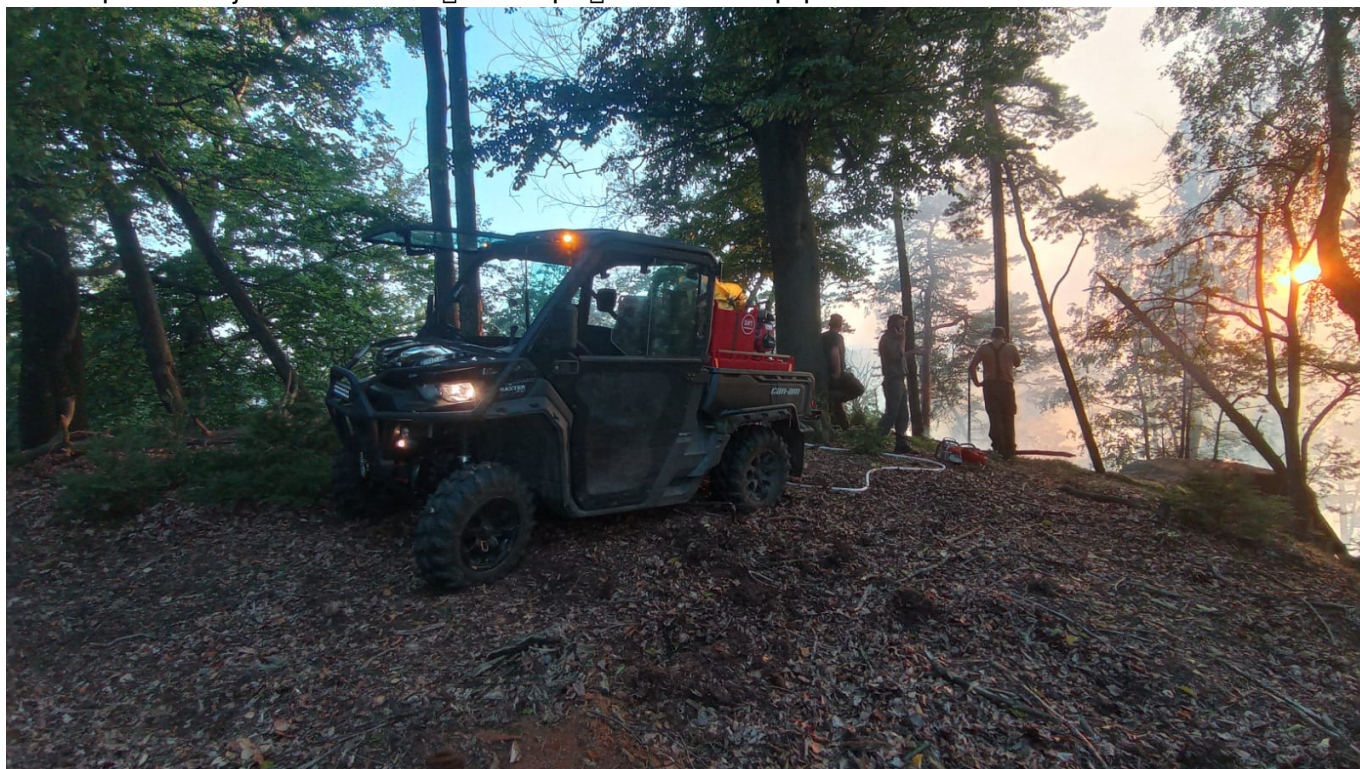
ÄtyÄkolka s hasebnÄ nÄ;stavbou, kterou sprá;va parku poÄÄdila po zkuÄ;enosti s loÄskÄ½m poÄ¾Ä;rem u HÄenska, pomohla pÄeklenout dobu, neÄ¾ hasiÄji poloÄ¾ili nÄkolik stovek metrÄ dlouhÄ vedenÄ pro ha;enÄ ze zemÄ. Foto: Miroslav RohlÄk
