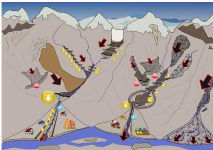
Vliv regulačních opatření na konektivitu hrubozrnných sedimentů a na tvorbu aluviálních kuželů v povodí (převzato z Marchi a kol., 2019).
