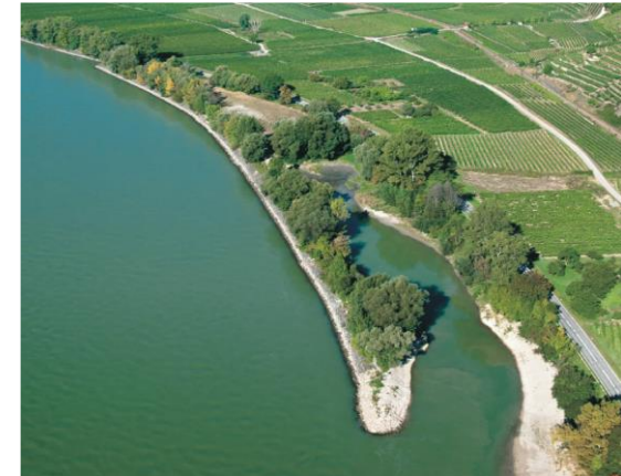
Revitalizovaná levobřežní částí Dunaje s vytvořenou zátočinou (zpětnými vodami) poblíž obce Dürnstein (převzato z Kraus a Kaufmann 2014).
